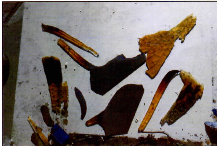
図 14 モジュールから脱落したガラス片
